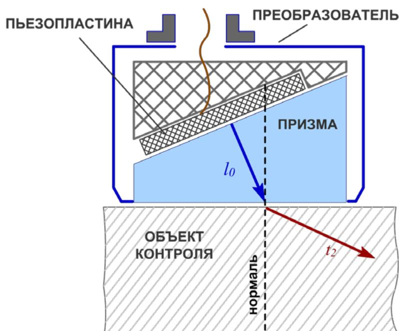
Рис. 2.6 – Схема прохождения волны из призмы преобразователя в объект контроля
